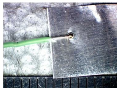
熱電対の溶接例
